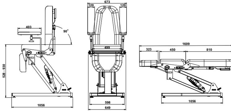
**Hauteur variable hydraulique / Hydraulic variable height**
